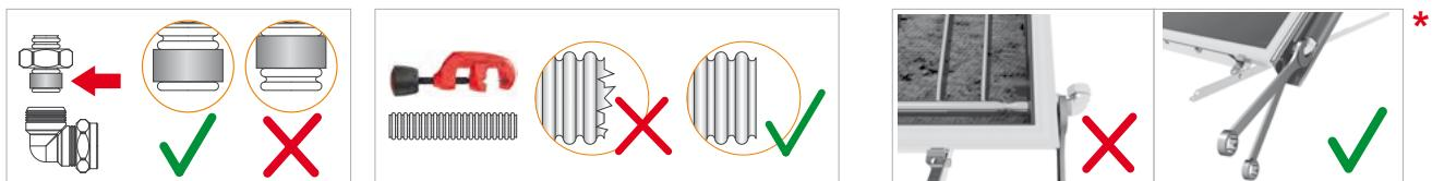
13. Τοποθετούμε το μικρό εύκαμπτο σωλήνα στο γωνιακό θηλυκό ρακόρ  $\frac{3}{4}''$ xDN16 INOX\* στο πλάι του μπόιλερ στο σημείο που είναι τοποθετημένη η ηλεκτρική αντίσταση και στην υποδοχή «εισαγωγή συλλέκτη».
