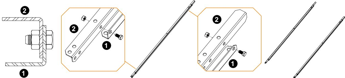
2. Τοποθετούμε το έλασμα 4, ανάμεσα από τα δυο Π που σχηματίσαμε στο προηγούμενο βήμα. Τοποθετούμε το έλασμα 16 ακριβώς από κάτω. Βιδώνουμε με τις βίδες M8 και τα παξιμάδια που περιέχονται στη συσκευασία. Επαναλαμβάνουμε και για το δεύτερο ζευγάρι ελασμάτων.
