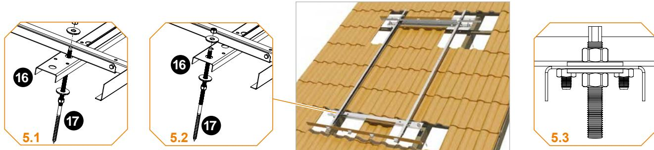
6. Σε περίπτωση τοποθέτησης συστήματος με 3 συλλέκτες, τοποθετούμε τις 2 επιπλέον βάσεις συστήματος ενός συλλέκτη, κατασκευασμένες με τον ίδιο τρόπο, δεξιά και αριστερά στην υπάρχουσα. Πάνω στις 3 βάσεις τοποθετούμε τους 3 συλλέκτες βάση των παρακάτω οδηγιών. Χρησιμοποιούμε τα ρακόρ μηχανικής σύσφιξης Ø22XØ22 για να ενώσουμε τους συλλέκτες μεταξύ τους και σφίγγουμε.
