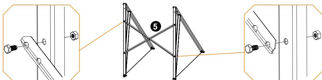
5. Σε περίπτωση μοντέλου με δύο συλλέκτες, τοποθετούμε το έλασμα (4) στήριξης του συλλέκτη στο κάτω μέρος και ανάμεσα στα κενά των ελασμάτων τοποθετούμε τα τέσσερα ελάσματα σύσφιξης (8) χωρίς να σφίξουμε τις βίδες M8 με τα παξιμάδια. Σε περίπτωση μοντέλου με ένα συλλέκτη δεν χρειάζεται να χρησιμοποιήσουμε το έλασμα 5. Ο συλλέκτης θα στηριχθεί με τα δύο ελάσματα σύσφιξης (8) όπως περιγράφεται στα (5a) και (5b).
