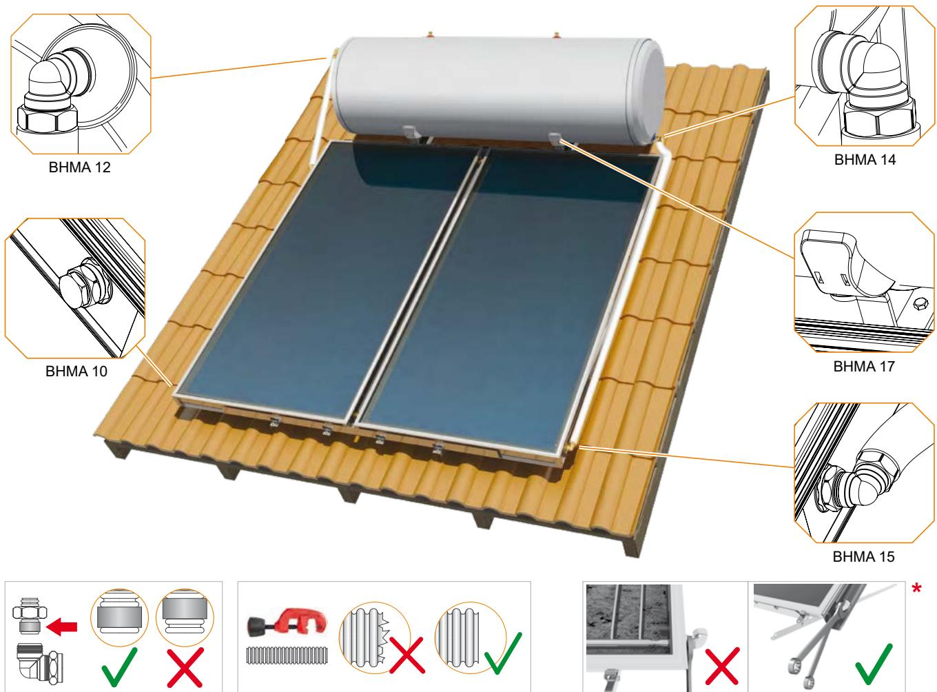
10. Τοποθετούμε και σφίγγουμε τις τάπτες μηχανικής σύσφιξης Ø22 στο επάνω δεξί και κάτω αριστερό άκρο του/ των συλλέκτη/κτων.\* Τοποθετούμε το μπόιλερ πάνω στη βάση με τα ηλεκτρικά μέρη αριστερά, βλέποντας τον ηλιακό θερμοσίφωνα από μπροστά.
