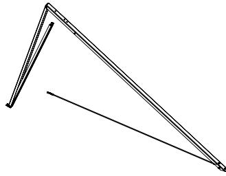
2. Βιδώνουμε το διαγώνιο έλασμα (3) στο έλασμα του συλλέκτη (1), χρησιμοποιώντας τη βίδα M8x60. Τοποθετήστε την ντίζα Rod M8 (7), όπως απεικονίζεται την εικόνα, βιδώστε την, χρησιμοποιώντας την ροδέλα και το παξιμάδι M8 και από τις δύο πλευρές του κάθετου (2) και διαγώνιου ελάσματος (3)
